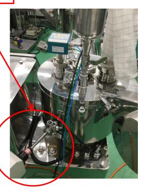
ハイスピードミキサ(FS25)へのモニタリング機器取付方法
